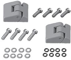
Hergestellt aus Aluminium-Druckguss. Öffnungswinkel ca. 170 Grad. Befestigungsvorlage und Edelstahl-Befestigungselemente inbegriffen. Zwei Scharniere pro Satz.
