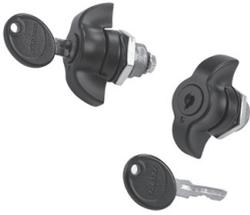
Knebelschloss mit Vorreiberverschluss. Schwarze Oberfläche. Dichtung, Montagemutter und ein Schlüssel mit dem Schlüsselcode 333 liegen bei. Der Einbau erfolgt über den vorhandenen Riegel. Der Riegel ist nicht im Lieferumfang des Knebelschlosses enthalten. In offener oder geschlossener Stellung einrastbar. Entspricht der Gehäuseklasse Typ 4, 12.
