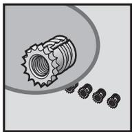
Vier gewindeformende M5-Messingeneinsätze werden in die ausgeformten Auflagen an der Unterseite des Gehäuses eingeschraubt. Die Einsätze weisen ein M3-Innengewinde auf.
