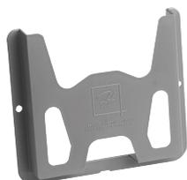
Dokumententaschen ermöglichen die bequeme Aufbewahrung von Schaltplänen, Bedienungsanleitungen und anderer Dokumentation im Gehäuse. Die dunkelgrauen Dokumententaschen bestehen aus schlagfestem Thermoplast und verfügen über Ausbrüche, damit der Inhalt jederzeit leicht zugänglich und gut sichtbar ist. Klebeband für Montagemöglichkeit ohne geschweißte Bolzen ist inbegriffen.
