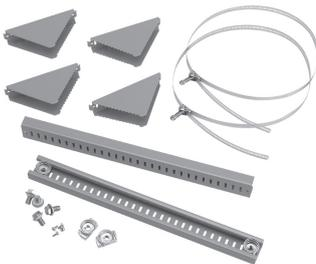
Dieser Satz wird für die Montage von CONCEPT-, Netzwerk- und Wandgehäusen an Masten mit verschiedenen Größen und Formen verwendet. Bringen Sie einfach die beschichtete Stange aus U-Profil-Stahl an den Befestigungslöchern an der Rückseite des Gehäuses an, und biegen Sie den Edelstahlstreifen um den Mast herum und durch die Stange. Der Satz umfasst zwei Profilstahlelemente zur Befestigung, zwei Bänder passend für Masten mit einem Durchmesser von 76 mm bis 305 mm und Befestigungselemente.
