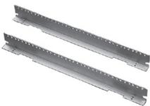
Winkelprofile ermöglichen die Befestigung von 19-Zoll-Ausbauteilen in 600 mm breiten Gehäusen. Beschichteter 1,5 mm starker Stahl mit Löchern mit 7 mm Durchmesser (Durchgangsbohrungstyp). 20 M5-Schrauben und 20 Käfigmuttern zur Befestigung von Winkelprofilen am Gehäuse sowie zur Befestigung von Einbauten an Winkelprofilen liegen bei.
