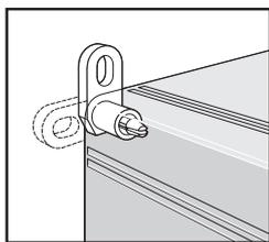
Der Befestigungswinkelsatz besteht aus vier Polycarbonat-Winkeln und vier gewindeformenden, beschichteten M3-Schrauben. Der Satz ist vor Ort montierbar. Der Satz kann für alle QLINE I-Gehäuse verwendet werden. Er entspricht den gelisteten Normen für Gehäuse.
