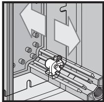
Der Ausbausatz für Montageplatten wird an den Schienen angebracht, die in die Ecken des Gehäuses geformt sind, um die Einstellung von vorn nach hinten über den gesamten Bereich zu erleichtern. Das Paket beinhaltet vier Beschläge aus Polyamid sowie beschichtete Schrauben. Der Satz kann für alle QLINE I-Gehäuse verwendet werden.
