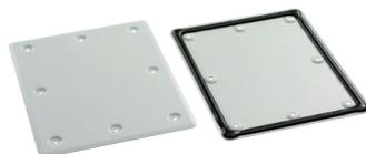
Abnehmbare Flanschplatten ermöglichen die Kabeleinführung und gewährleisten gleichzeitig die IP-/UL-/CSA-Schutzart des Schrankes. Oberfläche innen und außen: lichtgrauer Strukturlack aus Polyesterpulver, RAL 7035. Eingesäumte Dichtung, Befestigungselemente und Anleitung inbegriffen. Erfüllt bei sachgemäßer Montage IP66/UL/CSA Typ 4 und 12.
