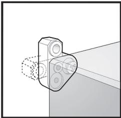
Der Befestigungswinkelsatz besteht aus vier Polycarbonat-Winkeln und vier gewindeformenden, beschichteten M4-Schrauben. Der Satz ist vor Ort montierbar. Er kann für alle QLINE D-Gehäuse verwendet werden. Er entspricht den gelisteten Normen für Gehäuse.
