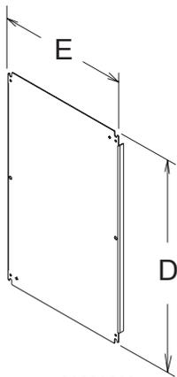
Bei Anwendungen mit begrenztem Platzangebot vergrößern Zubehörplatten die Schrankkapazität durch die Bereitstellung einer Montagefläche für 19-Zoll-Komponenten und Zubehör an der Rückseite des Schrankes. Die Platten werden mit Halsschrauben montiert, die dem Gehäuse beiliegen. In lackiertem Stahl oder Holz erhältlich.
